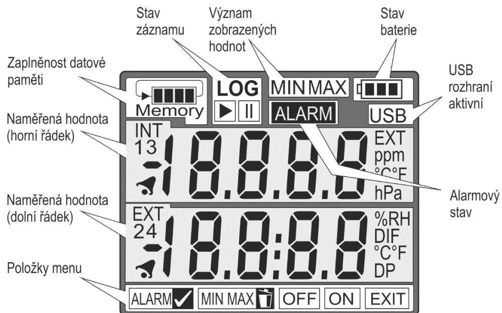
**Zaplněnost datové paměti** – poskytuje informaci o aktuálním stavu volného místa v datové paměti. Pokud nápis *Memory* bliká, znamená to, že byl překročen nastavený limit zaplněnosti paměti. Tento limit se nastavuje v konfiguraci přístroje a lze mu přiřadit různé akce (optická a akustická signalizace).
