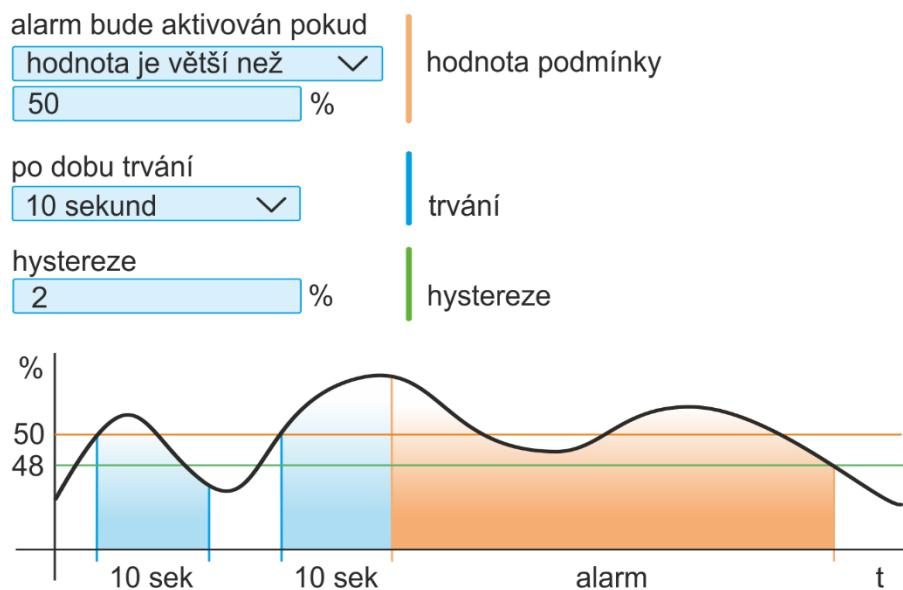
Tímto je dokončeno nastavení pro vznik alarmu a zbyvá určit, zda alarm bude indikován opticky na přístroji pomocí LED diody (*Optická signalizace – LED*) nebo akusticky (*Aktivovat interní akustickou signalizaci*).
