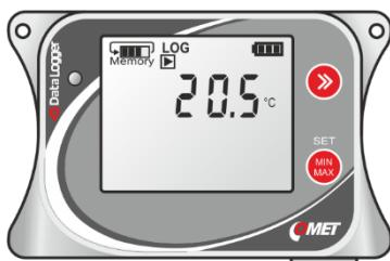
Tento model je vybaven pouze jedním interním čidlem pro měření teploty, není možné k němu připojit žádné další sondy a snímače. Vyznačuje se jednoduchým kompaktním provedením a relativně dlouhou odevzou na skokovou změnu teploty. Umísťuje se přímo do měřeného prostoru. Baterii v přístroji nelze nabíjet.
