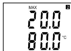
Na závěr se na LCD displeji zobrazí typ veličiny přiřazené 2. kanálu (zde „°C“ = teplota, „2“ = 2. kanál). Na dolním řádku se objeví hodnota měřené veličiny pro výstupní proud 20 mA (zde 80 °C).
