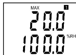
Po dalším stisku tlačítka se na LCD displeji zobrazí typ veličiny přiřazené 1. kanálu (zde „%RH“ = relativní vlhkost, „1“ = 1. kanál). Na dolním řádku se objeví hodnota měřené veličiny pro výstupní proud 20 mA (zde 100 %RH).
