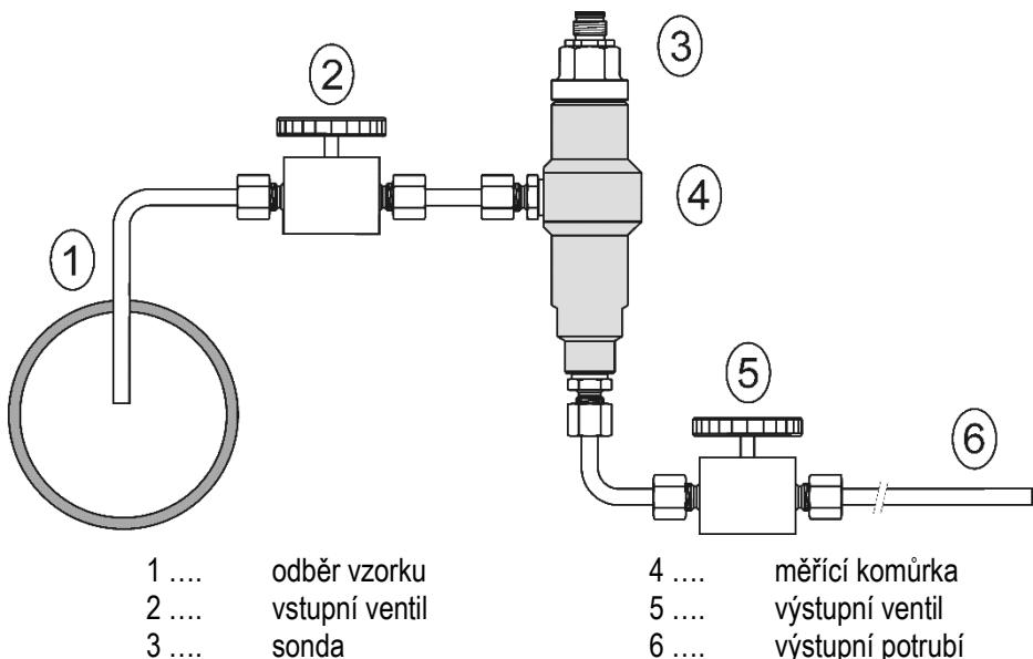
**odběr vzorku (1)** - konec trubky umístit do středu tlakového potrubí (rozložení vlhkosti v průřezu potrubí není homogenní). Pro dosažení krátké doby odezvy zkrátit délku vzorkovacího potrubí na minimum (jednotky metrů).
