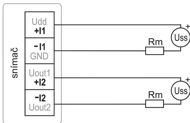
hodnota odporu smyčky  $Rc = Rm + \text{odpor vodičů}$  musí splňovat podmínu  $Rc[\Omega] < 40 \times Uss[V] - 360$
