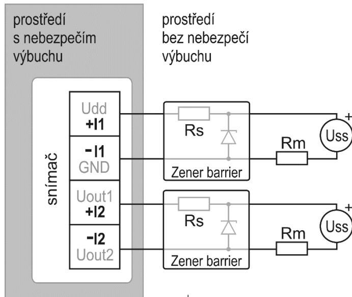
hodnota odporu smyčky  $Rc = Rs + Rm + \text{odpor vodičů}$  musí splňovat podmínu  $Rc[\Omega] < 40 \times Uss[V] - 360$
