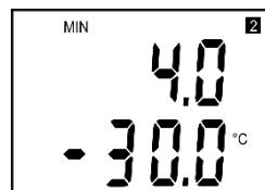
Dále se na LCD displeji zobrazí typ veličiny přiřazené 2. kanálu (zde „°C“ = teplota, „2“ = 2. kanál). Na dolním řádku se objeví hodnota měřené veličiny pro výstupní proud 4 mA (zde -30 °C).
