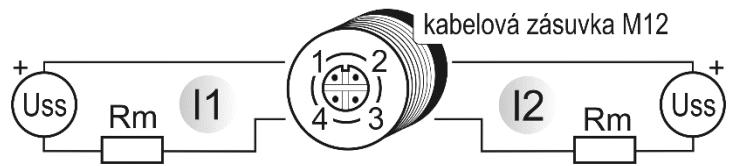
hodnota odporu smyčky  $R_c = R_m + \text{odpor vodičů}$  musí splňovat podmínu  $R_c[\Omega] < 40 \times U_{ss}[V] - 360$
