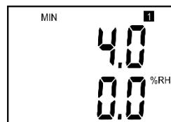
Na LCD displeji se zobrazí typ veličiny přiřazené 1. kanálu (zde „%RH“ = relativní vlhkost, „1“ = 1. kanál). Na dolním řádku se objeví hodnota měřené veličiny pro výstupní proud 4 mA (zde 0 %RH).
