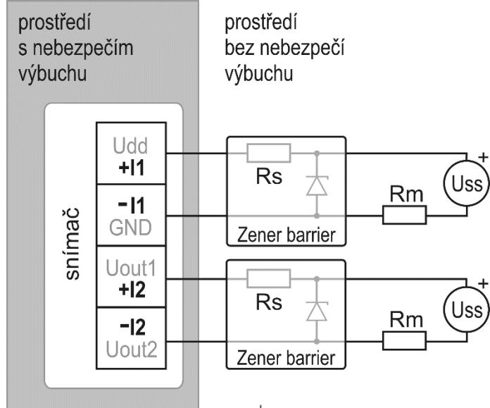
hodnota odporu smyčky  $Rc = Rs + Rm + \text{odpor vodičů}$  musí splňovat podmínu  $Rc[\Omega] < 40 \times Uss[V] - 360$
