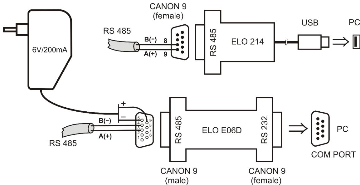
Pro připojení snímače s rozhraním RS485 k počítači můžete použít vhodný komerčně dostupný převodník. Zapojení provedte podle manuálu k převodníku. Při problémech s komunikací prověřte, zda není potřeba nakonfigurovat připojení rezistorů pro definici klidového stavu, zakončovacího rezistoru nebo časovou prodlevu. Na výše uvedeném obrázku jsou pro ilustraci uvedeny příklady připojení pomocí převodníků ELO E214 (připojuje se k USB rozhraní počítače) a ELO E06D (pro počítač s rozhraním RS232).
