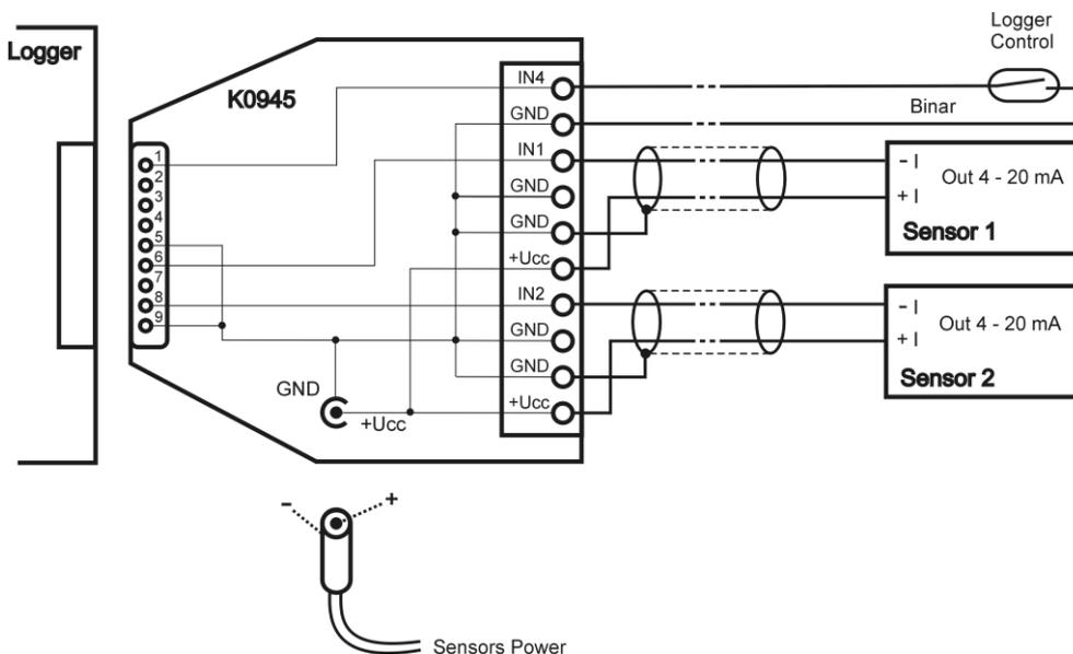
V tomto případě je možné proudové smyčky napájet např. ze síťového adaptéru, připojeného přes souosý napájecí konektor k adaptéru K0945. Velikost napájecího napětí závisí na typu použitých snímačů.
