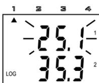
Aktivní alarm je indikován (je-li displej zapnut) blikáním hodnoty příslušné veličiny na displeji a současným rozsvícením šipky v horní části displeje, přičemž šipka 1 indikuje aktivní alarm pro veličinu 1. kanálu a šipka 2 veličinu 2. kanálu.
