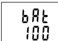
Následně je na cca 2 s zobrazen údaj o předpokládané zbývající kapacitě baterie (hodnota 0 až 100%). Údaj je platný, pokud je záznamník provozován v teplotním rozsahu -5 až +35 °C. Při provozu mimo tento rozsah klesá životnost baterie až o ¼, tzn. že pokud zobrazovaná zbývající kapacita baterie klesne pod 25%, je vhodné baterii vyměnit.
