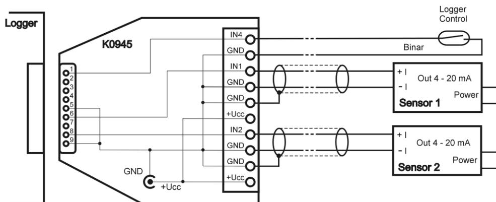
*Připojení záznamníku ke snímačům, vyžadujícím napájení proudové smyčky vnějším zdrojem*
