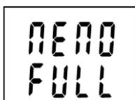
Je-li při necyklickém režimu záznamu paměť zcela zaplněna, záznamník se vypne a na displeji zůstane svítit hlášení MEMO FULL. To platí i v případě, že záznamník je provozován s vypnutým displejem.
