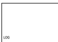
**Je-li displej vypnut**, platí výše popsaná zobrazení až do zobrazení údaje o předpokládané zbývající kapacitě baterie a poté displej zhasne – pro indikaci stavu „záznamník zapnut“ zůstává svítit symbol LOG, který bliká, pokud zaplnění paměti naměřených hodnot překročí 90%.
