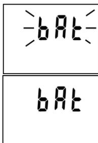
Zobrazuje-li se periodicky nápis BAT na horním řádku displeje (vždy na 1 s s intervalem 10 s), je tímto indikováno ukončení předpokládané životnosti baterie – přístroj je však nadále funkční v plném rozsahu. Baterii je vhodné co nejdříve vyměnit!
