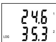
**Je-li zapnut displej**, následuje zobrazení naměřených hodnot – na horním řádku displeje se zobrazuje hodnota 1. kanálu (symbol 1), na dolním řádku hodnota 2. kanálu (symbol 2). Symbol LOG indikuje probíhající záznam – jestliže bliká, je paměť naměřených hodnot zaplněna více než z 90%.
