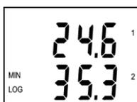
Zapnutý záznamník neustále (s intervalem 10 s) aktualizuje paměť minimální a maximální hodnoty obou kanálů. Je-li zapnuto zobrazení hodnot MIN/MAX, zobrazí se vždy po 5 s postupně minimální naměřené hodnoty (na displeji indikováno nápisem MIN) a poté podobně maximální naměřené hodnoty obou kanálů (na displeji indikováno nápisem MAX). Celý cyklus se pak periodicky opakuje, tzn. že následuje opět zobrazení aktuálně naměřených hodnot.
