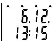
Došlo-li od posledního nastavení času ve vnitřních hodinách záznamníku k poklesu napětí baterie pod kritickou mez nebo k jejímu odpojení na dobu delší než cca 30 s, rozsvítí se po jeho zapnutí (při zobrazení data a času) na displeji všechny čtyři šipky jako varování, že čas v záznamníku nemusí být správný a musí být znovu z počítače nastaven. Všechny funkce záznamníku však pracují bez omezení.
