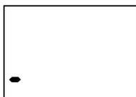
Pokud je záznamník s vypnutým displejem provozován navíc v režimu, kdy záznam probíhá pouze při aktivním alarmu, může být symbol LOG na displeji nahrazen sousedním znakem – (pomlčka). To nastane v případě, že hodnoty obou kanálů jsou v nastavených hranicích svých alarmů a záznam je proto zastaven. Zobrazený symbol indikuje, že záznamník je zapnut.
