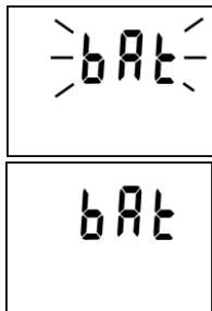
Zobrazuje-li se periodicky nápis BAT na horním řádku displeje (vždy na 1 s s intervalom 10 s), je tímto indikováno ukončení předpokládané životnosti baterie – přístroj je však nadále funkční v plném rozsahu. Baterii je vhodné co nejdříve vyměnit!
