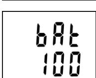
Následně je na cca 2 s zobrazen údaj o předpokládané zbývající kapacitě baterie (hodnota 0 až 100%). Údaj je platný, pokud je záznamník provozován v teplotním rozsahu -5 až +35 °C. Při provozu mimo tento rozsah klesá životnost baterie až o ¼, tzn. že pokud zobrazovaná zbývající kapacita baterie klesne pod 25%, je vhodné baterii vyměnit.
