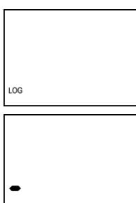
**Je-li displej vypnut**, platí výše popsaná zobrazení až do zobrazení údaje o předpokládané zbývající kapacitě baterie a poté displej zhasne – pro indikaci stavu „záznamník zapnut“ zůstává svítit symbol LOG, který bliká, pokud zaplnění paměti naměřených hodnot překročí 90 %.
