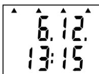
Došlo-li od posledního nastavení času ve vnitřních hodinách záznamníku k poklesu napětí baterie pod kritickou mez nebo k jejímu odpojení na dobu delší než cca 30 s, rozsvítí se po jeho zapnutí (při zobrazení data a času) na displeji všechny čtyři šipky jako varování, že čas v záznamníku nemusí být správný a musí být znova z počítače nastaven. Všechny funkce záznamníku však pracují bez omezení.
