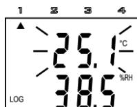
Aktivní alarm je indikován (je-li displej zapnut) blikáním hodnoty příslušné veličiny na displeji a současným rozsvícením šipky v horní části displeje, přičemž šipka 1 indikuje aktivní alarm pro okolní teplotu, šipka 2 relativní vlhkost a šipka 4 teplotu rosného bodu.
