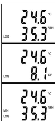
**Je-li zapnut displej**, následuje zobrazení naměřených hodnot – na horním řádku displeje se zobrazuje okolní teplota (°C), na dolním řádku relativní vlhkost vzduchu (%RH). Symbol LOG indikuje probíhající záznam – jestliže bliká, je paměť naměřených hodnot zaplněna více než z 90 %.
