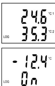
**Je-li zapnut displej**, následuje zobrazení naměřených hodnot – na horním řádku displeje se zobrazuje teplota 1. kanálu (°C 1), na dolním řádku teplota 2. kanálu (°C 2). Symbol LOG indikuje probíhající záznam – jestliže bliká, je paměť naměřených hodnot zaplněna více než z 90%.
