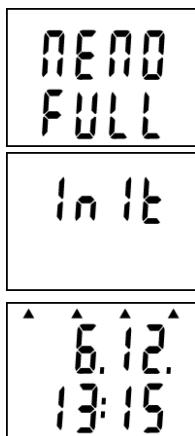
Je-li při necyklickém režimu záznamu paměť zcela zaplněna, záznamník se vypne a na displeji zůstane svítit hlášení MEMO FULL. To platí i v případě, že záznamník je provozován s vypnutým displejem.
