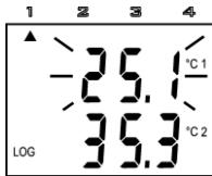
Aktivní alarm je indikován (je-li displej zapnut) blikáním hodnoty příslušné veličiny na displeji a současným rozsvícením šipky v horní části displeje, přičemž šipka 1 indikuje aktivní alarm pro teplotu 1. kanálu, šipka 2 teplotu 2. kanálu a šipka 3 teplotu 3. kanálu.
