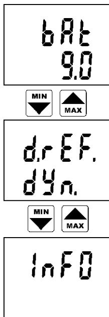
Zobrazuje se orientační hodnota napětí částečně zatížené baterie. Z této hodnoty lze posoudit stav baterie.
