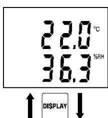
Na horním řádku displeje se zobrazuje teplota vzduchu ( $^{\circ}\text{C}$ ), na dolním řádku relativní vlhkost vzduchu (%RH).
