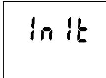
Došlo-li od posledního nastavení času ve vnitřních hodinách přístroje k poklesu napětí baterie pod kritickou mez nebo k jejímu odpojení na dobu delší než cca 1 min, proběhne po zapnutí nová inicializace přístroje (nápis INIT může svítit až 12 s!).
