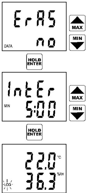
Přístroj dále nabízí možnost vymazání záznamové paměti (ERAS). Nemá-li být paměť před spuštěním záznamu vymazána, stačí potvrdit klávesou ENTER nabízenou volbu ERAS NO (nemazat).
