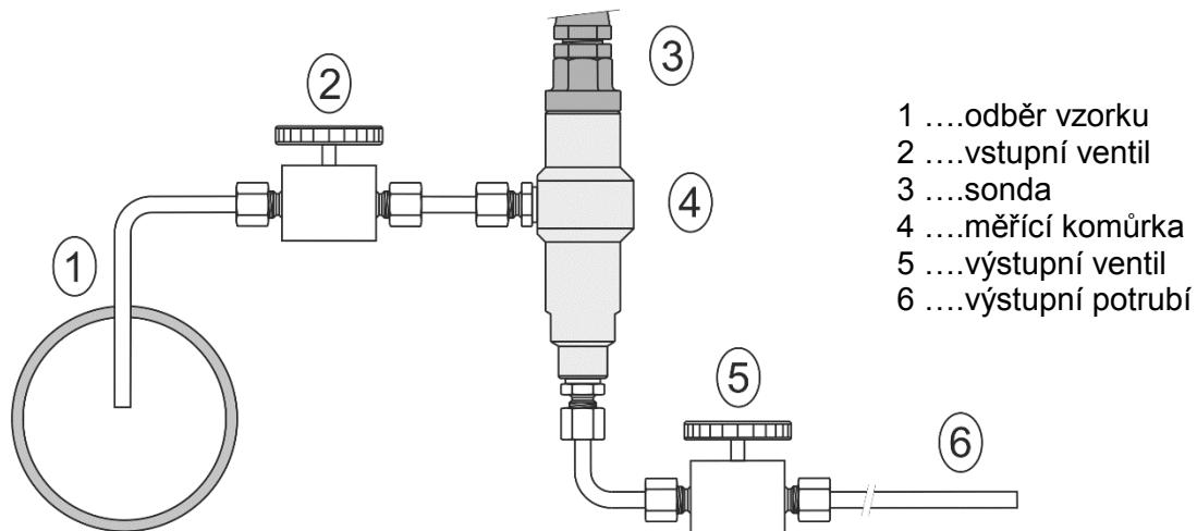
**odběr vzorku (1)** - konec trubky umístit do středu tlakového potrubí (rozložení vlhkosti v průřezu potrubí není homogenní). Pro dosažení krátké doby odezvy zkrátit délku vzorkovacího potrubí na minimum (jednotky metrů).
