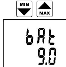
Zobrazuje se orientační hodnota napětí částečně zatížené baterie. Z této hodnoty lze posoudit stav baterie.
