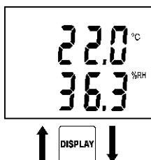
Na horním rádku displeje se zobrazuje teplota vzduchu ( $^{\circ}\text{C}$ ), na dolním rádku relativní vlhkost vzduchu (%RH).
