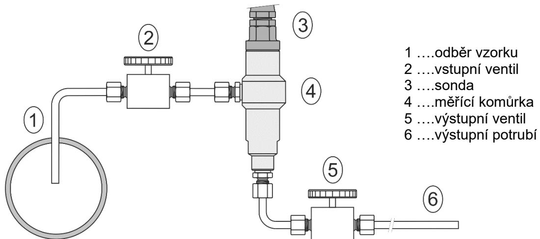
**odběr vzorku (1)** - konec trubky umístit do středu tlakového potrubí (rozložení vlhkosti v průřezu potrubí není homogenní). Pro dosažení krátké doby odesky zkrátit délku vzorkovacího potrubí na minimum (jednotky metrů).
