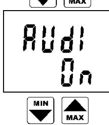
Indikuje zapnutí (On) nebo vypnutí (OFF) akustické signalizace překročení hranic alarmů. Stiskem klávesy ENTER lze aktuální stav změnit v opačný.
