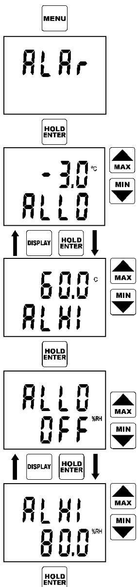
Aktivace alarmů každé jednotlivé veličiny může být zakázána nastavením dolní meze alarmu příslušné veličiny na její maximální nastavitelnou hodnotu, což je indikováno nápisem OFF místo číselné hodnoty. Hodnota horní meze téhož alarmu je pak lhostejná.
