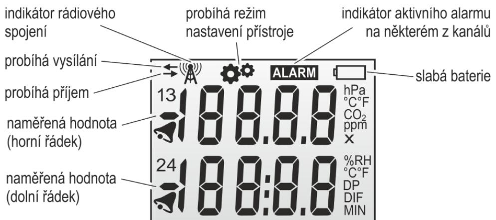
**Indikátor rádiového spojení** – indikuje úspěšnou aktivaci přístroje v síti LoRaWAN®. Je-li přístroj v dosahu sítě, rozsvítí se indikátor cca 15 s po zapnutí přístroje a zůstane svítit. Indikátor začne blikat, pokud déle než 23 h nepřijde žádná rádiová zpráva ze sítě do přístroje. Pokud tento stav trvá déle než 48 h, indikátor zhasne a indikuje tak pravděpodobnou ztrátu spojení se sítí.
