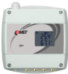
Snímač W0941 s výstupem do sítě LoRaWAN měří teplotu ze čtyř externí sond Pt1000 na kabelu s konektorem CINCH. Přístroje LoRa jsou napájeny vyměnitelnou baterií s životností až 10 let (standardně 3 roky). K dispozici je také externí napájení s volitelným příslušenstvím. Snímač lze s vhodnou krytkou použít i v náročnějších podmínkách.
