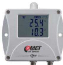
Snímač W3910 s výstupem do sítě LoRaWAN měří teplotu a vlhkost z vestavěného vnitřního čidla s možností instalace do měřeného prostoru díky krytí IP65. Přístroje LoRa jsou napájeny vyměnitelnou baterií s životností až 10 let (standardně 3 roky). K dispozici je také externí napájení s volitelným příslušenstvím. Snímač lze s vhodnou krytkou použít i v náročnějších podmínkách.
