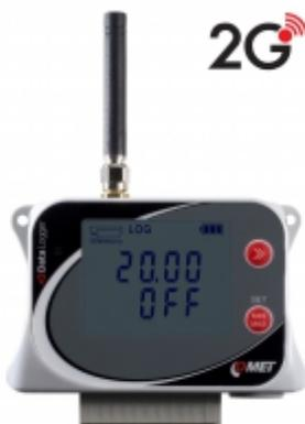
GSM datalogger s modemem je určen pro záznam ze 3 proudových vstupů 0-20mA a 1 binárního vstupu. V případě překročení nastavených mezí umožňuje zasílání alarmových SMS a JSON zpráv přes GPRS datové připojení. Měřené hodnoty mohou být zasílány do internetového úložiště [COMET Cloud](#), což je kompletní monitorovací, alarmovací a analytický systém.
