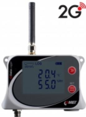
GSM datalogger je určen pro záznam teploty a vlhkosti z externí sondy. V případě překročení nastavených mezí umožňuje zasílání alarmových SMS a JSON zpráv přes GPRS datové připojení. Měřené hodnoty mohou být zasílány do internetového úložiště [COMET Cloud](#), což je kompletní monitorovací, alarmovací a analytický systém.
