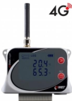
GSM datalogger je určen pro záznam teplot až ze čtyř externích sond Pt1000 připojených na svorkovnici. V případě překročení nastavených mezí umožňuje zasílání alarmových SMS a JSON zpráv přes 4G datové připojení. Měřené hodnoty mohou být zasílány do internetového úložiště [COMET Cloud](#), což je kompletní monitorovací, alarmovací a analytický systém.
