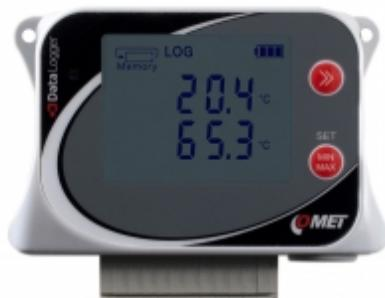
Datalogger je určen pro záznam teplot až ze čtyř externích sond Pt1000 připojených na svorkovnici.
