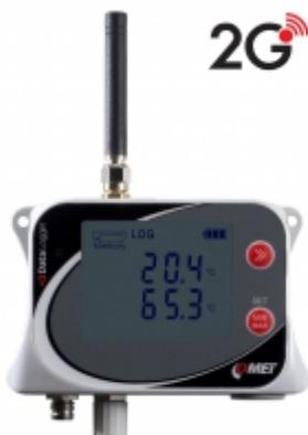
GSM datalogger je určen pro záznam teplot až ze dvou externích sond Pt1000. V případě překročení nastavených mezí umožňuje zasílání alarmových SMS a JSON zpráv přes GPRS datové připojení. Měřené hodnoty mohou být zasílány do internetového úložiště [COMET Cloud](#), což je kompletní monitorovací, alarmovací a analytický systém.
