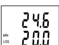
Zapnutý záznamník neustále (s intervalem 10 s) aktualizuje paměť minimální a maximální hodnoty. Je-li zapnuto zobrazení hodnot MIN/MAX, zobrazí se vždy po 5 s postupně minimální naměřené hodnoty (na displeji indikováno nápisem MIN) a poté podobně maximální naměřené hodnoty (na displeji indikováno nápisem MAX). Celý cyklus se pak periodicky opakuje, tzn. že následuje opět zobrazení aktuálně naměřených hodnot.
