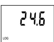
**Je-li zapnut displej**, následuje zobrazení naměřených hodnot. Symbol LOG indikuje probíhající záznam – jestliže bliká, je paměť naměřených hodnot zaplněna více než z 90%.
