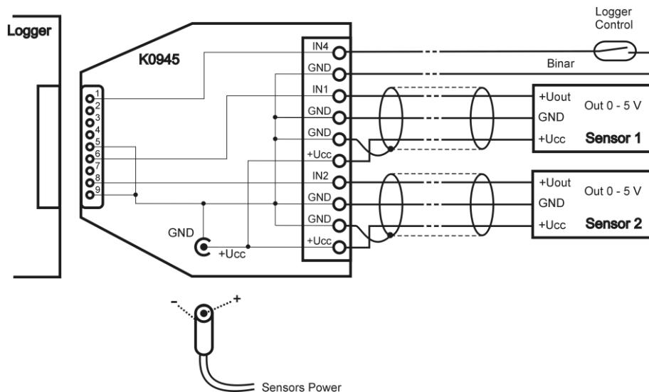
V tomto případě je možné snímače napájet např. ze síťového adaptéru, připojeného přes souosý napájecí konektor k adaptéru K0945. Velikost napájecího napětí a výkon použitého síťového adaptéru závisí na typu použitých snímačů.
