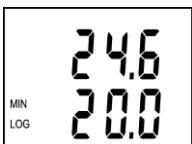
Zapnutý záznamník neustále (s intervalem 10 s) aktualizuje paměť minimální a maximální hodnoty. Je-li zapnuto zobrazení hodnot MIN/MAX, zobrazí se vždy po 5 s postupně minimální naměřené hodnoty (na displeji indikováno nápisem MIN) a poté podobně maximální naměřené hodnoty (na displeji indikováno nápisem MAX). Celý cyklus se pak periodicky opakuje, tzn. že následuje opět zobrazení aktuálně naměřených hodnot.
