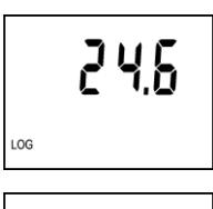
**Je-li zapnut displej**, následuje zobrazení naměřených hodnot. Symbol LOG indikuje probíhající záznam – jestliže bliká, je paměť naměřených hodnot zaplněna více než z 90%.
