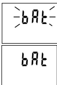
Zobrazuje-li se periodicky nápis BAT na horním rádku displeje (vždy na 1 s s intervalom 10 s), je tímto indikováno ukončení předpokládané životnosti baterie – přístroj je však nadále funkční v plném rozsahu. Baterii je vhodné co nejdříve vyměnit!
