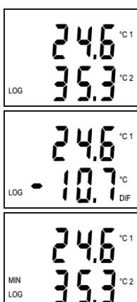
**Je-li zapnut displej**, následuje zobrazení naměřených hodnot – na horním řádku displeje se zobrazuje teplota 1. kanálu ( $^{\circ}\text{C}$  1), na dolním řádku teplota 2. kanálu ( $^{\circ}\text{C}$  2). Symbol LOG indikuje probíhající záznam – jestliže bliká, je paměť naměřených hodnot zaplněna více než z 90%.
