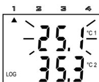
Aktivní alarm je indikován (je-li displej zapnut) blikáním hodnoty příslušné veličiny na displeji a současným rozsvícením šipky v horní části displeje, přičemž šipka 1 indikuje aktivní alarm pro teplotu 1. kanálu, šipka 2 teplotu 2. kanálu a šipka 4 rozdíl teplot.
