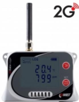
GSM datalogger je určen pro záznam teploty, vlhkosti, atmosférického tlaku a CO<sub>2</sub>. V případě překročení nastavených mezí umožnuje zasílání alarmových SMS a JSON zpráv přes GPRS datové připojení. Měřené hodnoty mohou být zasílány do internetového úložiště [COMET Cloud](#), což je kompletní monitorovací, alarmovací a analytický systém.
