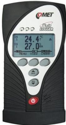
Bateriový datalogger s Ethernetovým rozhraním se 4 univerzálními vstupy pro měření napětí 0-10V, proudu 0-20mA, dvoustavového signálu a čítání impulsů.
